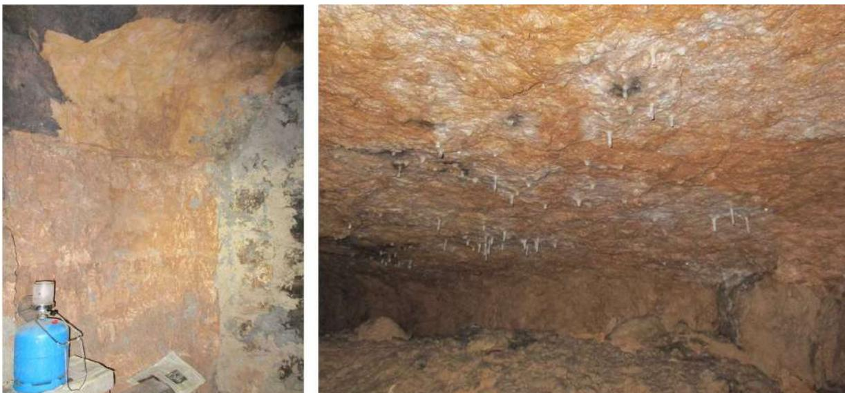
*Cambio de estrato en torno a la cota 858 metros. Izquierda: contacto neto en bodega 14 (Juan de Arenal). Derecha: estalactitas en la parte superior del plano de estratificación en bodega 30 (Montañés-Las Setas)*
