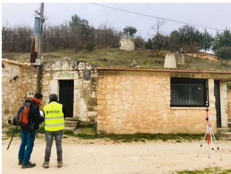
Para la **zona exterior** del barrio de bodegas se ha llevado a cabo un levantamiento topográfico y se ha obtenido una ortofoto de alta resolución. La toma de datos georreferenciada la ha realizado la empresa Precisa HDS por técnicas de fotogrametría de objeto cercado con dron. Los medios empleados para este cometido han sido el GPS Leica GS14 y el equipo de vuelo RPAS DJI Phantom4-RTK.
